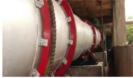
回转式高效节能烘干机是目前选矿设备中的主要设备之一，它主要用于烘干一定湿度和粒度范围内的颗粒物料，它广泛应用于建材、冶金、化工、水泥工业烘干矿渣、粘土等物料。该机主要由回转体、扬料板、传动装置、支撑装置及密封圈等部件组成。具有结构合理，制作精良，产量高，能耗低，运转方便等优点。如干粉砂浆行业所用的黄砂，铸造行业用的各种规格型砂，建材水泥行业用的高炉矿渣，小粒度粘土，化工行业用于不起化学变化、不怕高温及烟尘弄脏的小颗粒物料。根据不同行业对烘干后物料的终水分要求，该设备烘干后的物料含水量可达 1-0.5% 及以下。
